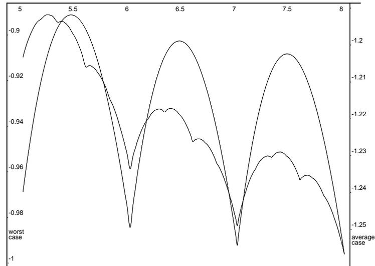
Figure 1 : Les complexités du tri-fusion dans le cas le pire et dans le cas moyen cachent des fonctions périodiques en  $\lg n$ , qui apparaissent quand on considère les suites  $f_n/n - \lg n$  en fonction de  $\lg n$ . Le tracé le plus lisse correspond au cas le pire. Pour le cas moyen on a une courbe de nature fractale que l'on peut obtenir en superposant des copies réduites de la précédente décalées de  $\lg 2$ ,  $\lg 3$ , etc.
